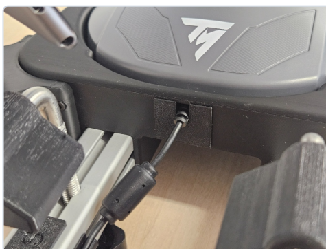
Bild 2: Montage des Kabelschutzes
